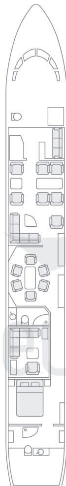
Versión ejecutiva del Boeing 737-700. Puede presentar diferentes configuraciones interiores dependiendo del operador, con la cabina dividida en varias secciones. Generalmente dispone de un dormitorio, un baño con ducha, una sala de reuniones, una oficina y una sala de estar.
